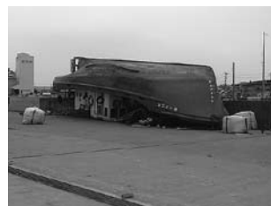
写真7 船舶の転覆乗り上げ。船舶は、港内では危険な漂流物となる（塩釜港区西ふ頭観光棧橋 浸水深約2.5m）
